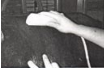
Figura 10: Ubicación del transductor para la medición del %GI.
